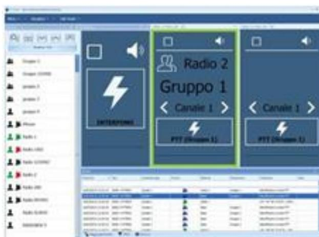
Figura 196: Software della gestione del traffico radio – modalità RoIP
