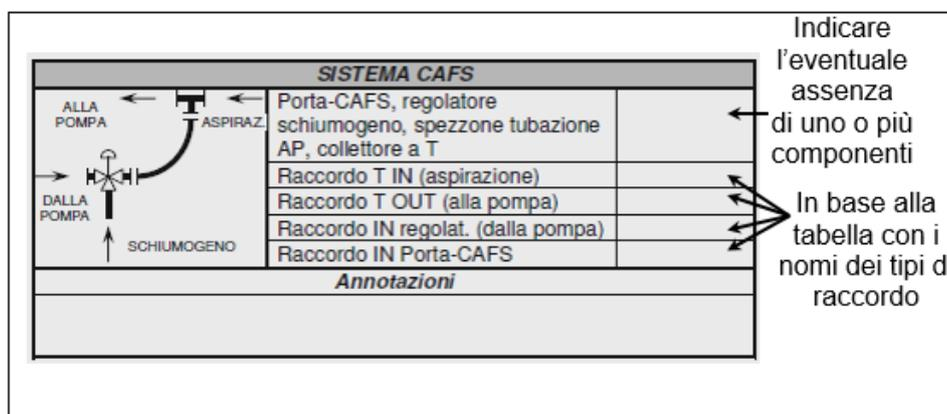
Figura 170: schema di compilazione sistema CAFS
