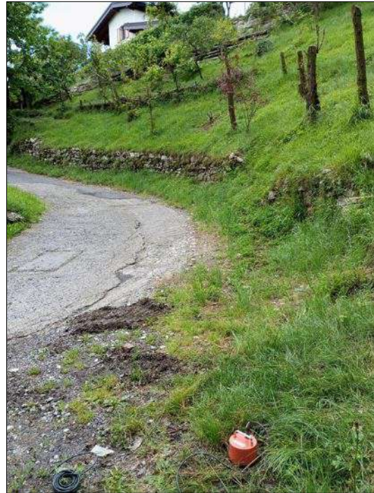
Misura del microtremore sismico mediante tecnica H.V.S.R.
