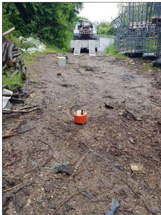
Misura del microtremore sismico mediante tecnica H.V.S.R.
