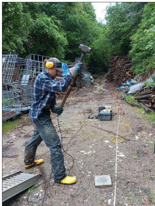
Shot sismico verticale per la generazione delle onde di Rayleigh
